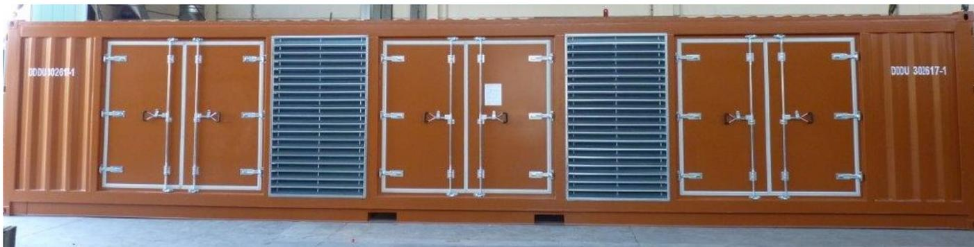
Le centrali di produzione della serie DUAL sono costituite da un container 40'BOX STD silenziato o supersilenziato in funzione della rumorosità residua richiesta, sono dotate di due gruppi elettrogeni di identica potenza, di quadro di parallelo automatico e di cisterna di stoccaggio combustibile di adeguata capacità.
