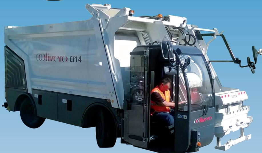
Il CF è un compattatore a **caricamento frontale rivoluzionario** nell'interfaccia con l'operatore grazie al posizionamento del dispositivo di sollevamento cassonetto a fianco della cabina di guida.
