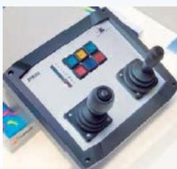
ZRS 202: Con un doppio joystick, la ZRS 202 consente un controllo contemporaneo ed ottimale sia della lama frontale, sia di quella laterale. Il controllo della pressione con funzione di scarico e carico è regolabile in continuo tramite un valore calibrato. Con un tasto di controllo viene attivata la funzione flottante.
