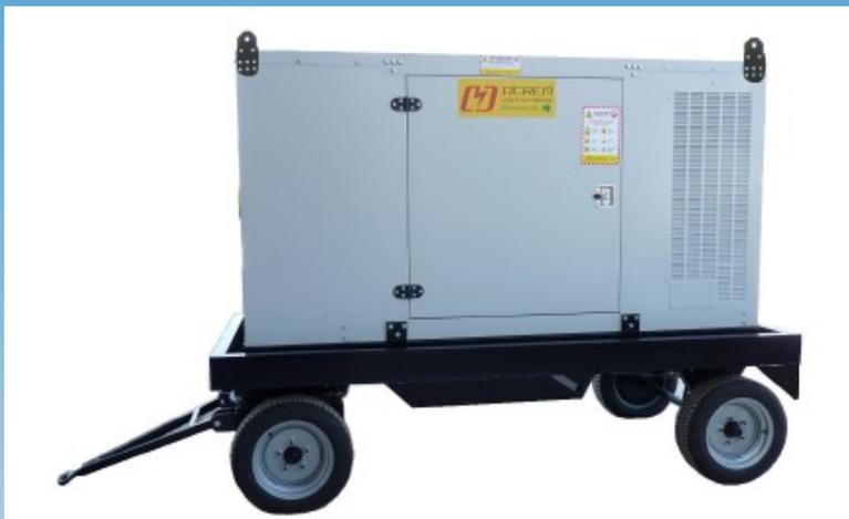
Il gruppo elettrogeno speciale per avviamento aeromobili modello IV100S eroga una tensione di 115/200 VAC e di 28 VDC, con una frequenza di 400 Hz ed una potenza fino a 100 kVA, particolarmente adatta per l'alimentazione a terra di aeromobili ad ala rotante o per velivoli pattugliatori turbolentica, quali, ad esempio, il P180.
