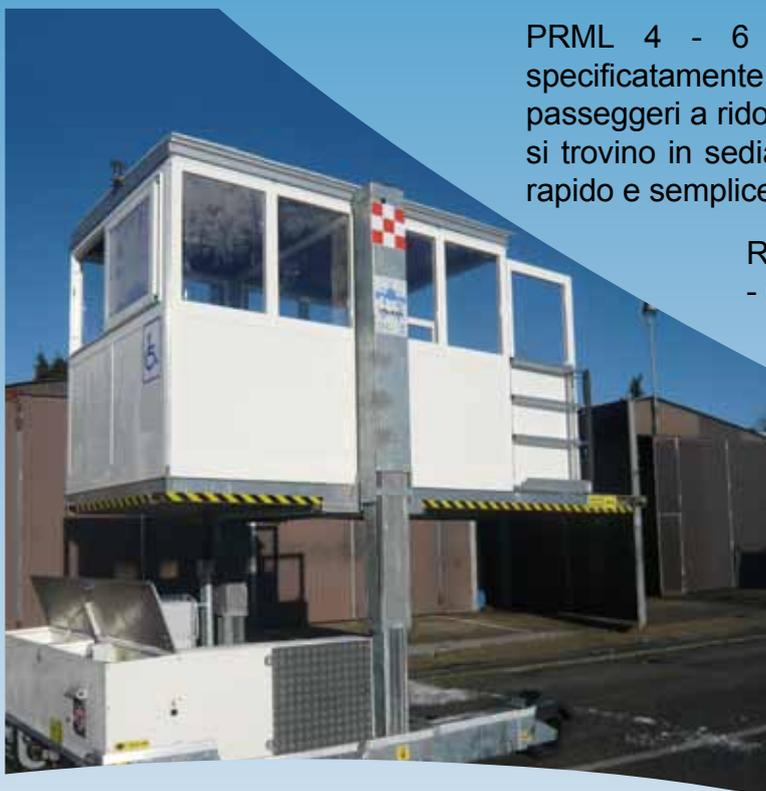
PRML 4 - 6 è un veicolo semovente progettato specificatamente per trasferire, imbarcare e disimbarcare passeggeri a ridotta mobilità a bordo di aeromobili, sia che si trovino in sedia a rotelle sia in barella, in modo sicuro, rapido e semplice.
