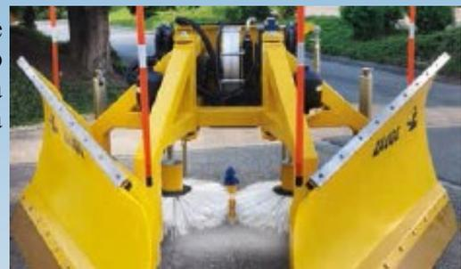
Attraverso un sistema di pulizia speciale (tecnologia spazzola e soffiante) i residui di neve attorno alle lampade viene facilmente e completamente rimosso.
