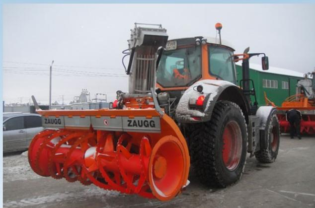
Tutte le frese sono inoltre dotate di camino di scarico orientabile, completo di una o più alette, a controllo meccanico od idraulico, per meglio dirigere il flusso di neve.
