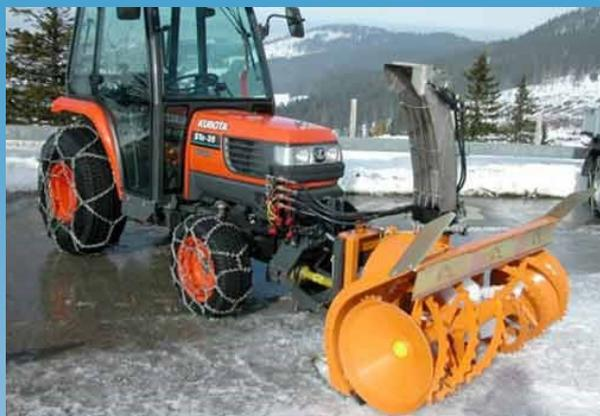
Le frese da neve Zaugg rappresentano il massimo per quanto riguarda lo sgombero di neve compatta o ghiacciata, come spesso capita nelle nostre località alpine e dell'Appennino settentrionale. Dotate di rotor in acciaio ad altissima resistenza e di scatola di trasmissione con frizione anti sovraccarico, le frese da neve Zaugg assicurano una perfetta pulizia con grande confort e sicurezza per l'operatore.
