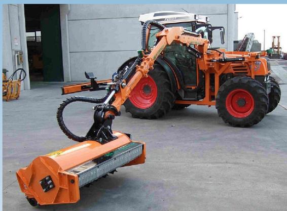
Disponiamo di soluzioni con bracci decespugliatori, posteriori e laterali, di varie dimensioni e potenze, installabili sui nostri trattori Fendt e Kubota, il meglio che si possa trovare sul mercato, con possibilità di montare teste trincianti, aspiranti, barre falcianti o raiber.
