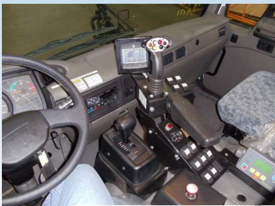
L'operatore ha a disposizione un quadro comandi ergonomico ed intuitivo. Inoltre, grazie al riscaldatore elettrico del bitume, non è necessario scaricare e lavare l'impianto a fine turno, è sufficiente connettere la macchina alla normale rete elettrica.
