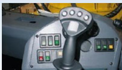
sono facilmente accessibili e visibili da parte dell'operatore. I dati relativi ai parametri di funzionamento della macchina vengono raccolti tramite interfaccia CAN-Bus
