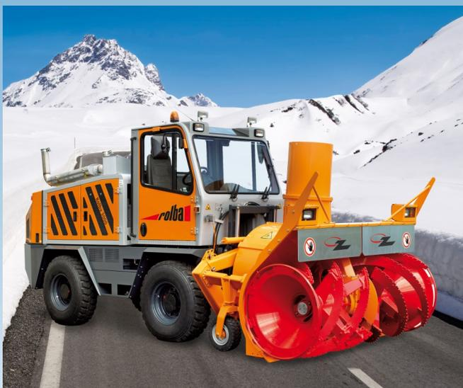
La serie 600 può essere dotata di cabina elevabile fino a 700 mm, per una ancora migliore visibilità da parte dell'operatore
