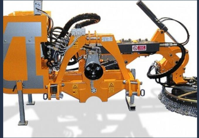
Macchina multifunzione per la manutenzione dei bordi stradali. con un'unica portattrezzi è possibile svolgere numerose attività, come sfalcio dell'erba, pulizia sotto il guard-rail, diserbo del bordo stradale e manutenzione dei fossi. La DSL può essere montata anteriormente o posteriormente, secondo le necessità dell'operatore e, grazie al suo sistema di attacco rapido, è possibile cambiare l'attrezzo terminale in pochissimi minuti.
