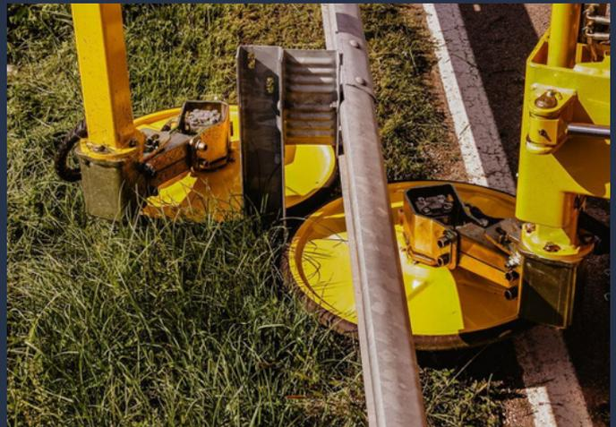
Falciatrice - scavallatrice che permette lo sfalcio dell'erba lungo i bordi stradali anche in presenza di guardrail, segnaletica o qualsiasi ostacolo di altra natura. È dotata di due dischi di taglio installati su bracci indipendenti, di cui il più esterno è ribaltabile a 180° per i superamento degli ostacoli più alti di 1,7 m; ogni disco è equipaggiato con una bordura in gomma ed un richiamo a molla che consentono l'aggiramento automatico dei pali contemporaneamente allo sfalcio dell'erba.
