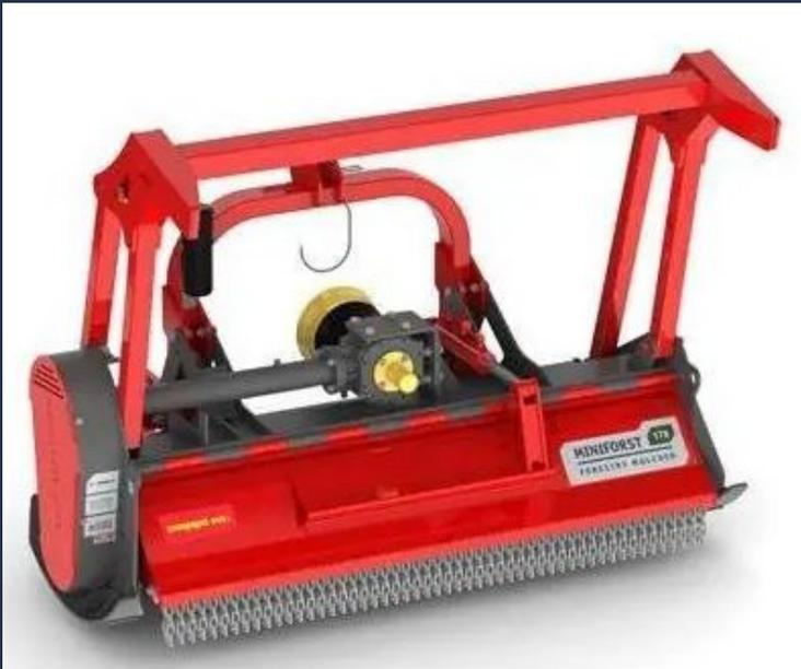
Il telaio è robusto, realizzato in acciaio resistente all'usura, la copertura della cinghia rinforzata, il cilindro idraulico ben protetto e le catene di protezione assicurano una lunga durata.
