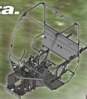
**Robusto telaio strutturale con struttura di protezione contro il ribaltamento (ARCO) di serie**
