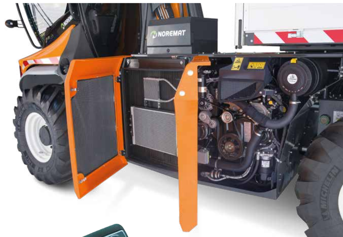
Coperture incernierate per un accesso rapido ai vani motore e radiatore
